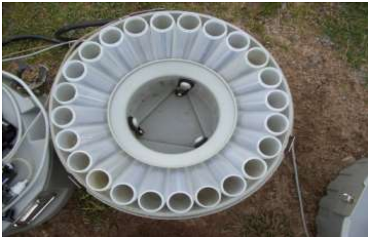
Figur 3. Då provtagaren öppnas syns i botten 24 stycken en-liters Flaskor för uppsamling av prov (Fotograf: Mika Thomasdotter).
