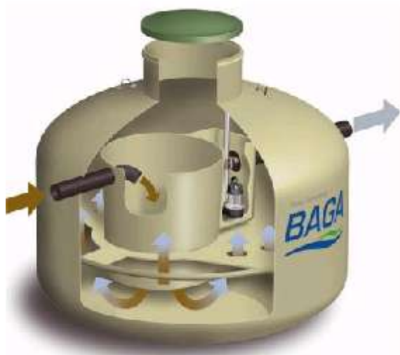
Figur 5. En skiss av tekniken i BAGAs slamavskiljare ser ut (2. BAGA, 2008).
